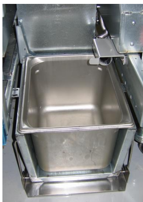
Figure 3 : Insérer le bac intérieur du réservoir d'huile dans l'unité de fonte.
