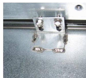
Figure 5 : Fixer l'unité de fonte sur les rails des deux côtés.
