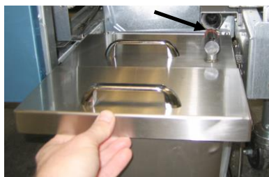
Figure 4 : Placer le couvercle sur le bac et faire glisser le tube de captage d'huile vers le raccord femelle d'aspiration.
